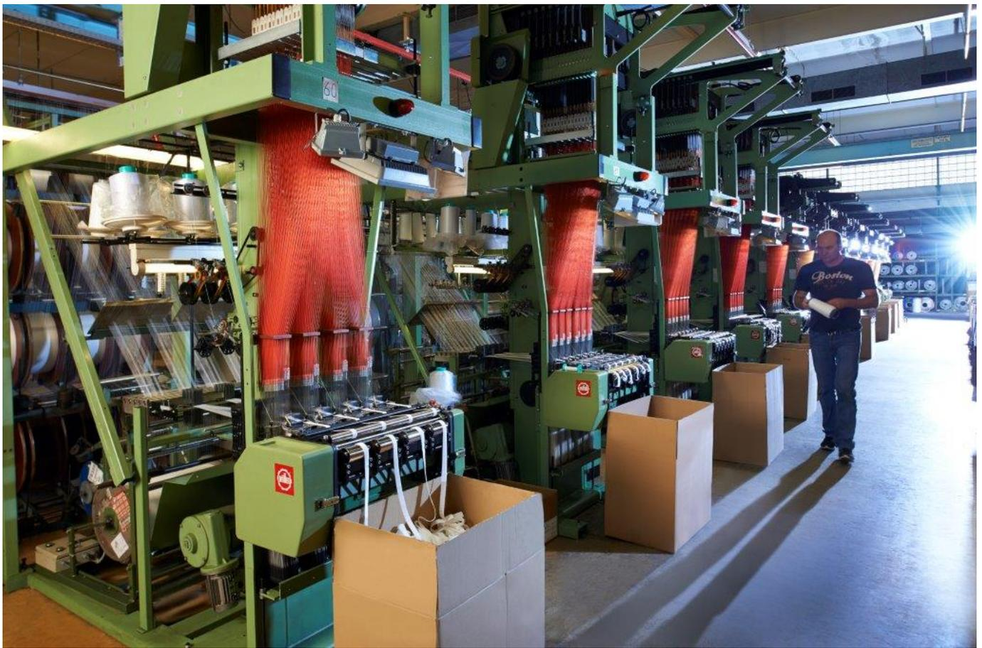
Unsere Bänder werden in Altshausen auf unterschiedlichen Bandwebmaschinen und Häkelmaschinen der führenden Hersteller Comez, Jakob Müller und Mageba hergestellt.
